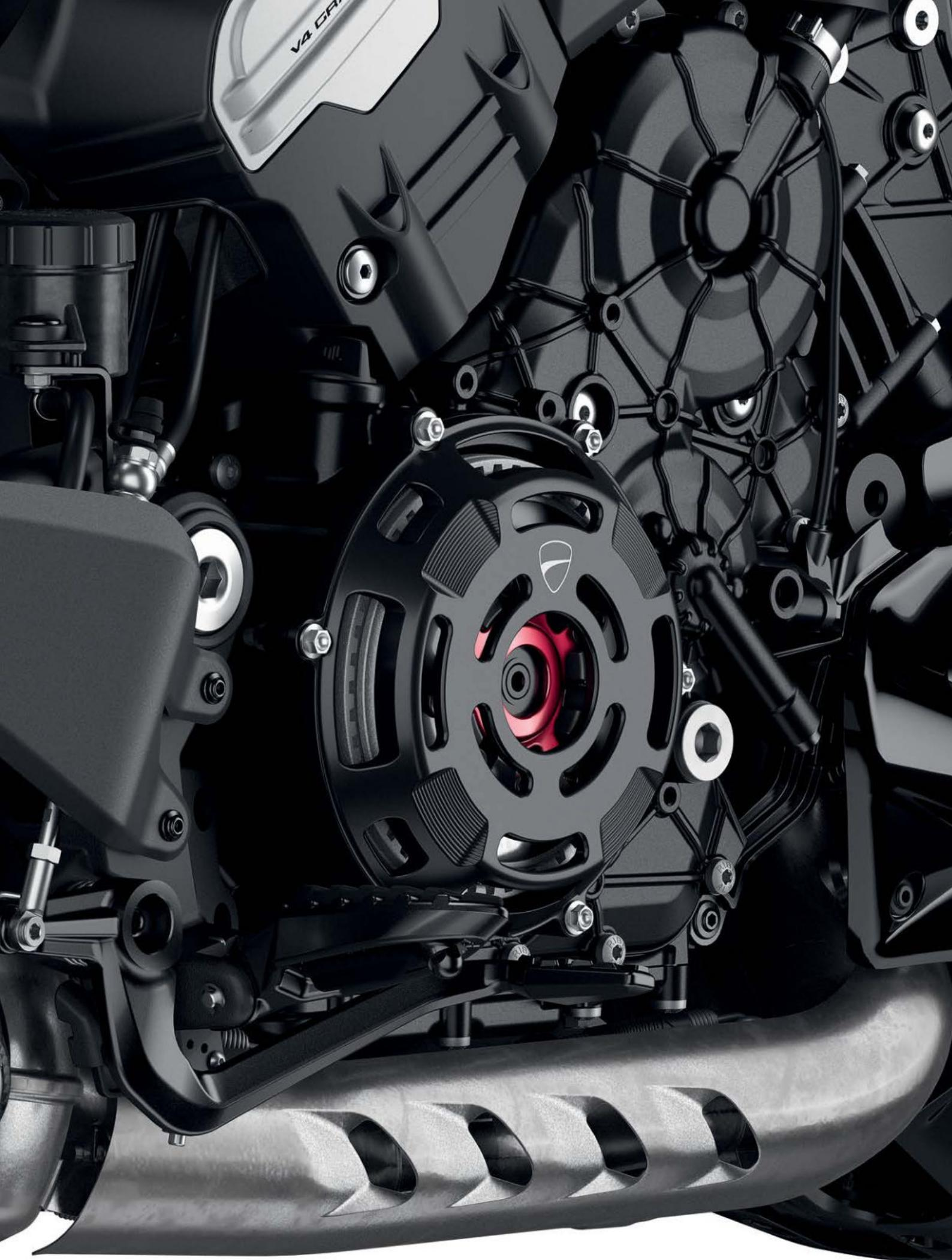
Cover frizione a secco. Studiata per offrire un'ottimale ventilazione della frizione a secco, è realizzata in alluminio dal pieno, finemente lavorato da CNC, e anodizzato nero per garantire un'elevata resistenza e mantenere l'aspetto originale nel tempo. Il design lineare ma decisamente esalta la preziosa estetica della moto, donandole un autentico stile racing ed esaltando il tipico sound sportivo della frizione a secco.
