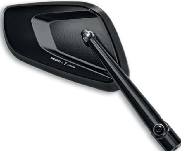
Specchio retrovisore sinistro in alluminio. Con il suo design unico, permette il minimo impatto aerodinamico donando un tocco di stile inconfondibile alla moto. Sviluppato in collaborazione con Rizoma.
