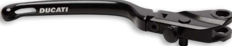
Leva frizione. Realizzata con lavorazione 3D e caratterizzata da una linea tipicamente sportiva. Regolabile e snodata, per ridurre la possibilità di rottura. La leggerezza ed aerodinamicità, unite ad un elevato grip, forniscono un alto livello di performance. Sviluppata in collaborazione con Rizoma.
