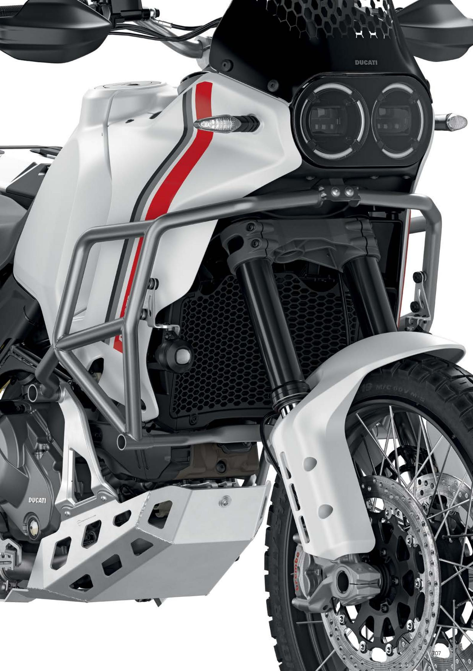
Protezione pompa acqua. L'accessorio perfetto per proteggere la pompa del circuito di raffreddamento da possibili cadute e urti derivanti dall'uso della moto su percorsi accidentati o nell'utilizzo quotidiano. Realizzata in acciaio inox, si integra perfettamente con il paramotore in tubi d'acciaio, risultando un particolare discreto ma altamente funzionale.
