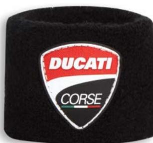
Polsino serbatoio fluido frizione. Ampiamente utilizzato in ambito Racing, nasce per salvaguardare la carrozzeria dall'accidentale fuoriuscita di liquido, oltre che per proteggere dai raggi UV, che possono causare il degrado del liquido stesso. Migliora l'estetica del serbatoietto di serie.
