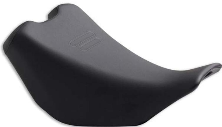
Sella bassa pilota. Accessorio che riduce l'altezza della seduta del pilota di 10 mm, facilitando l'appoggio a terra e garantendo maggiore stabilità e sicurezza, anche in fuoristrada, oltre a offrire un ottimo comfort.
