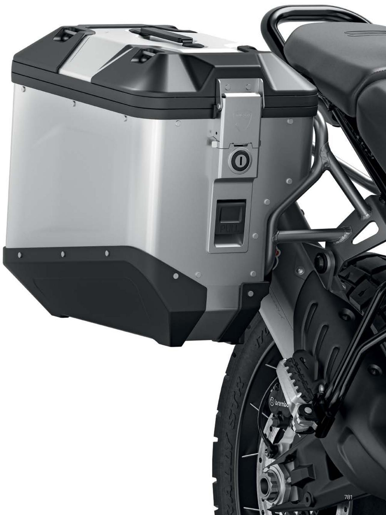
Telaietti per valigie laterali. Coppia di pratici e resistenti accessori che consentono il montaggio delle valigie in alluminio sulla DesertX. Sistema realizzato in acciaio inox e dotato di una robusta struttura che offre un'ottima stabilità alle borse laterali, garantendo al contempo un'estrema facilità di montaggio.
